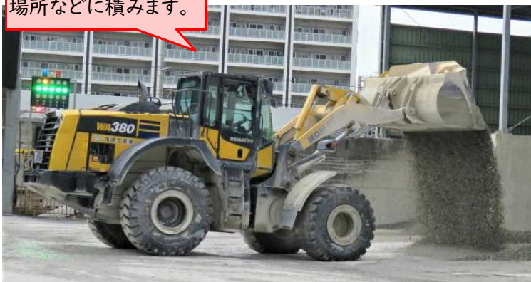
ホイールローダーは、大きなバケットで土をすくって、トラックや別の場所などに積みます。
